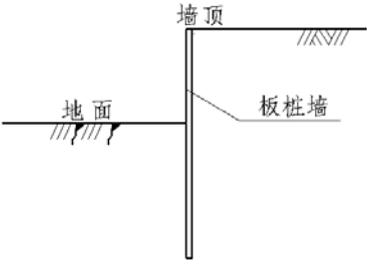
图 7 无锚碇的板桩式挡土墙结构示意图
