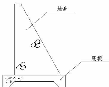
图 1 重力式挡土墙结构示意图
