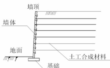
图 10 加筋式挡土墙结构示意图
