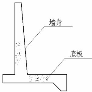
图4 悬臂式挡土墙结构示意图
