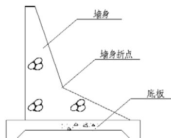
图 2 半重力式挡土墙结构示意图
