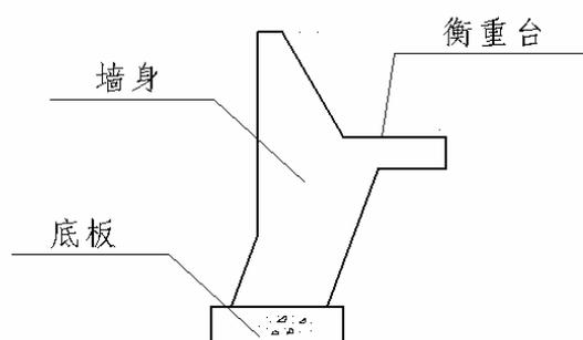
图 3 衡重式挡土墙结构示意图
