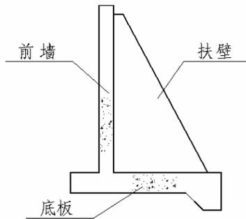
图5 扶壁式挡土墙结构示意图
