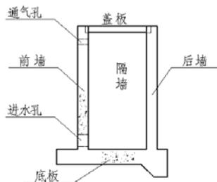
图6 空箱式挡土墙结构示意图
