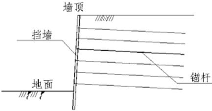
图 9 锚杆式挡土墙结构示意图
