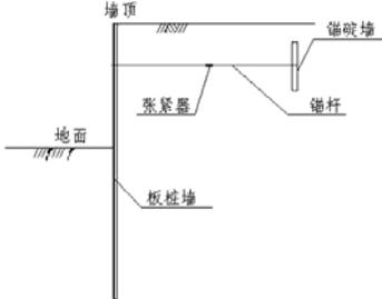
图 8 有锚碇的板桩式挡土墙结构示意图
