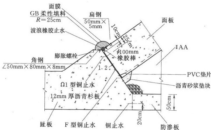
图 10 水布垭面板堆石坝周边缝止水结构
