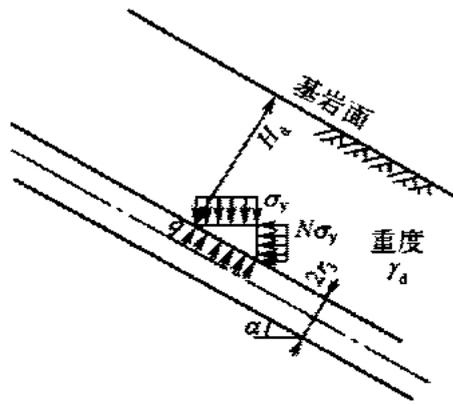
图 13 钢管上覆盖层计算图
