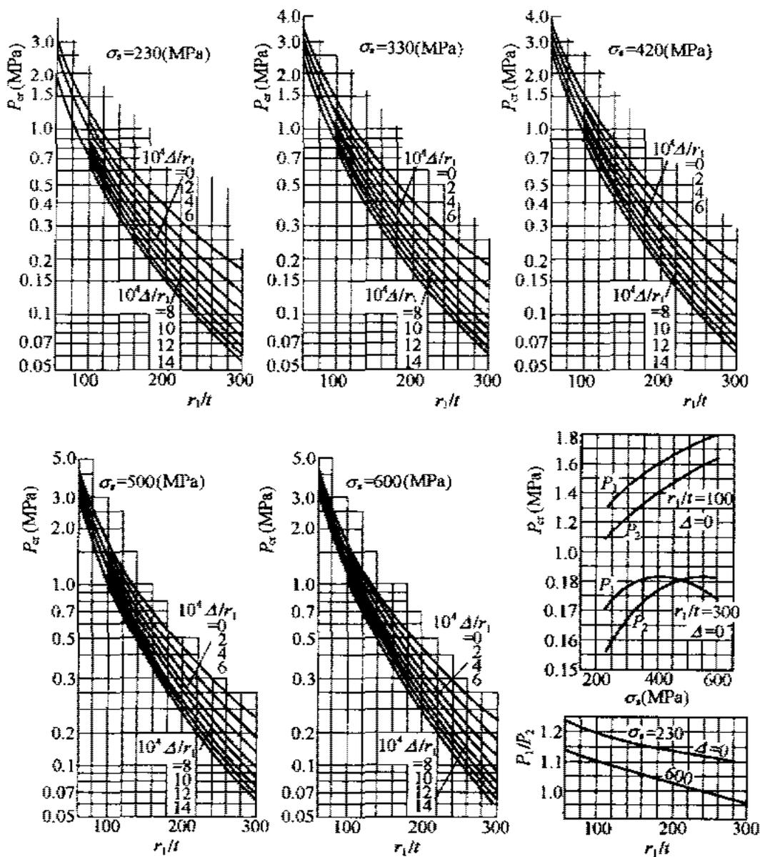
图 18 埋管临界外压力曲线阿姆斯图兹公式 (1969,  $\nu = 1.5 \sim \beta$ )
