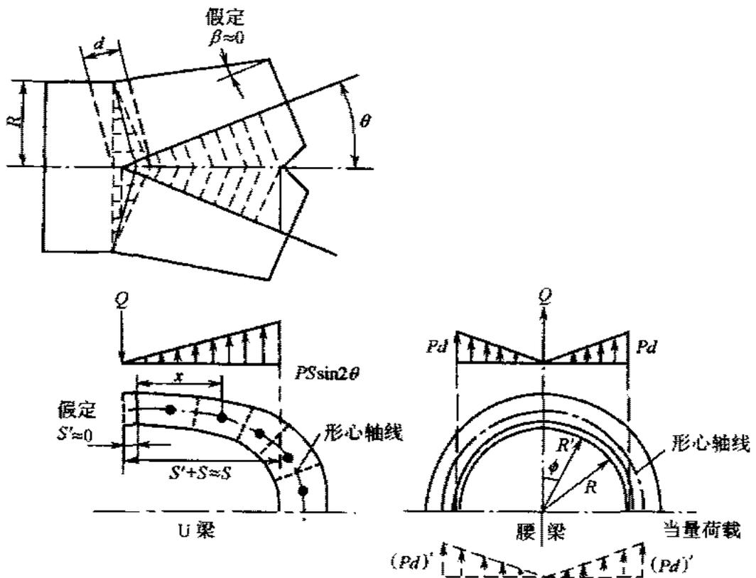
图 E. 2. 7 简化计算的荷载图形
