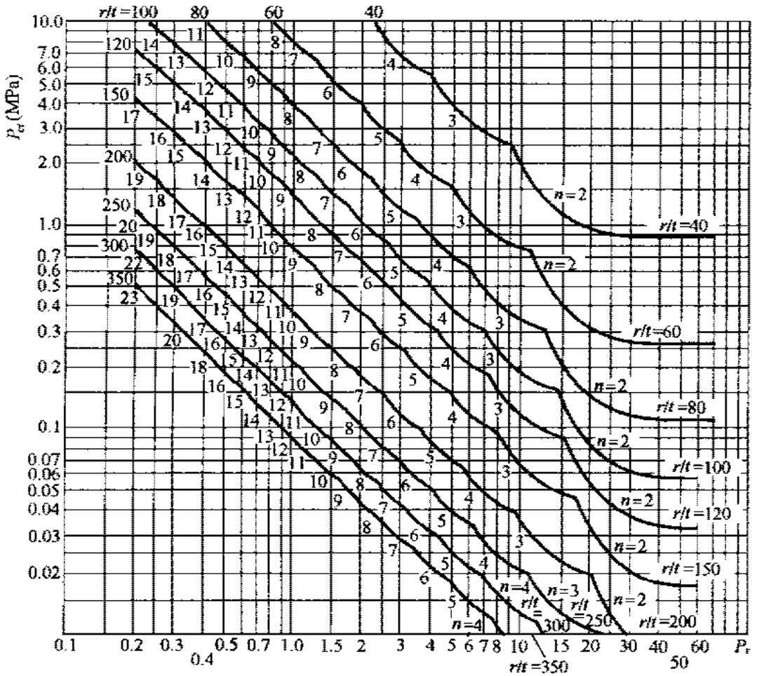
图 A. 3. 2 明管临界外压力曲线
