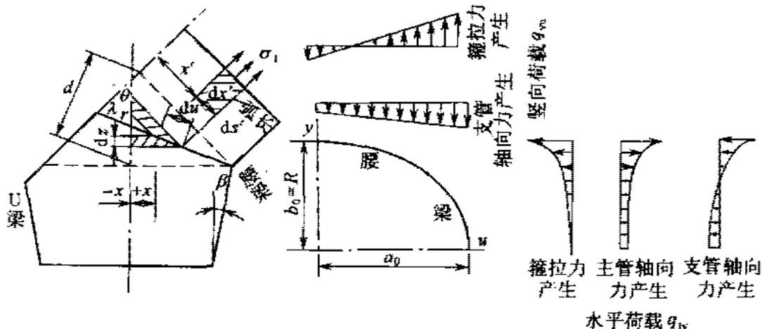
图 E. 2. 2 腰梁的荷载图形
