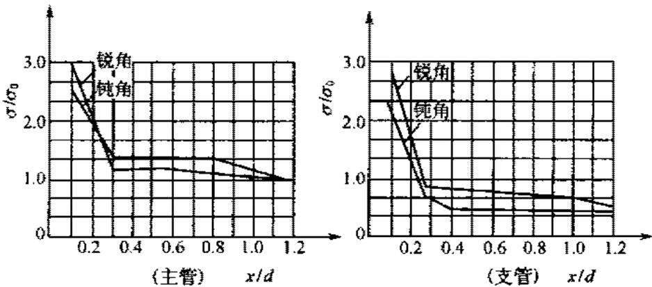
图 E. 4. 3-2 孔口应力集中系数  $\sigma/\sigma_0$  衰减
