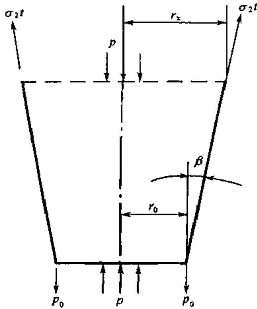
图 E. 2. 3-2 主、支管轴向力平衡图 (二)
