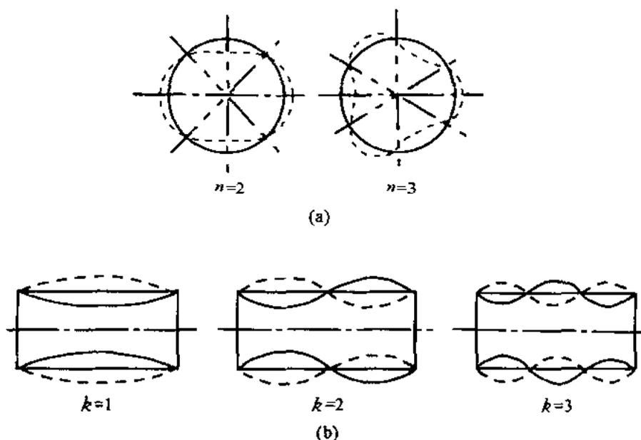
图 5 无加劲环的圆筒壁振动
