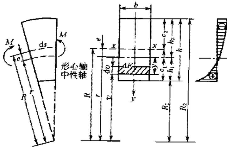
图 E. 2. 4-2 矩形截面的曲梁弯曲应力
