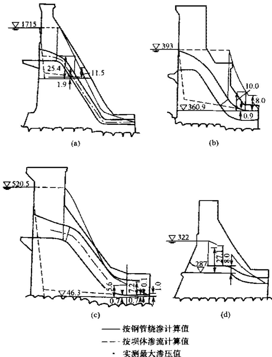
图6 坝体渗流值和钢管绕渗值的比较图
