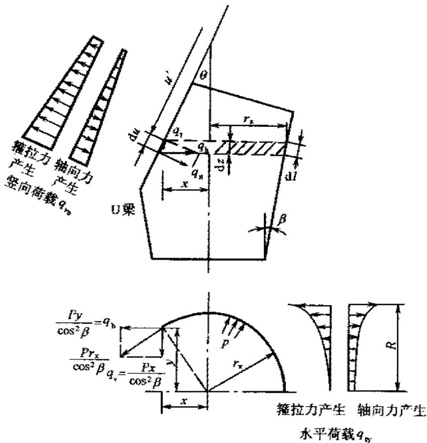
图 E. 2. 1-2 U 梁的荷载图形
