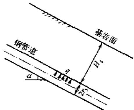
图 B. 1.1-3 埋管上覆盖层厚度示意图
