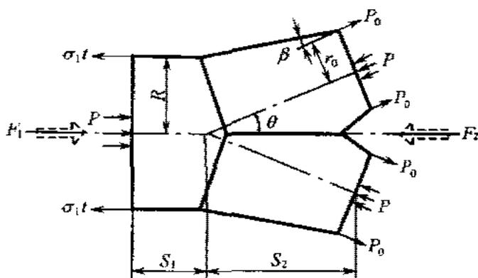
图 E. 2. 3-1 主、支管轴向力平衡图 (一)
