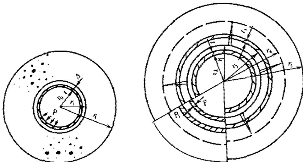
图 C.1.1-1 混凝土未开裂情况      图 C.1.1-2 混凝土部分开裂情况
